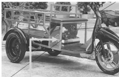
ชุดควบคุมการจ่ายพลังงานไฟฟ้า
