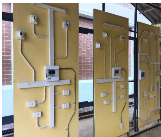
รูปที่ 1 ชุดฝึกทักษะการต่อวงจรการติดตั้งอุปกรณ์ไฟฟ้าในอาคาร ด้วยท่อและรางพีวีซี ตามมาตรฐานการติดตั้งไฟฟ้า
