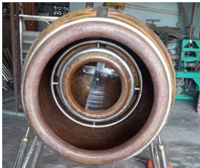
ภาพที่ 2 สร้างส่วนโครงสร้างโอ่งคั่วเมล็ดกาแฟชั้นนอกและชั้นใน
