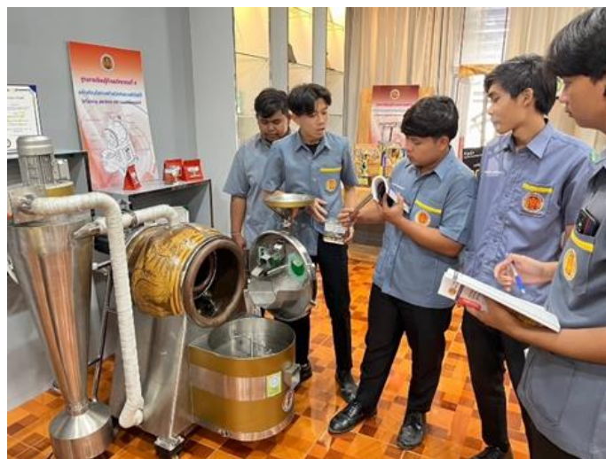
ภาพที่ 5 การทดลองใช้เครื่องคั่วกาแฟด้วยโอ่งดินชนิดไร้ควันในวิชาโครงการ
