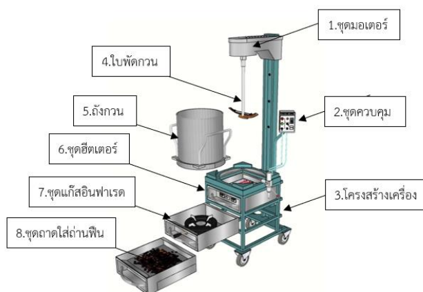
ภาพที่ 4 ส่วนประกอบเครื่องผลิตซอสกะปิปรุงรสรระบบพลังงานความร้อน 3 ระบบ
