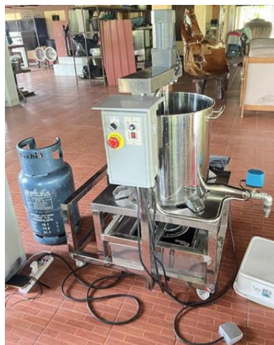
ภาพที่ 3 เครื่องผลิตซอสกะปิปรุงรสรระบบพลังงานความร้อน 3 ระบบ
