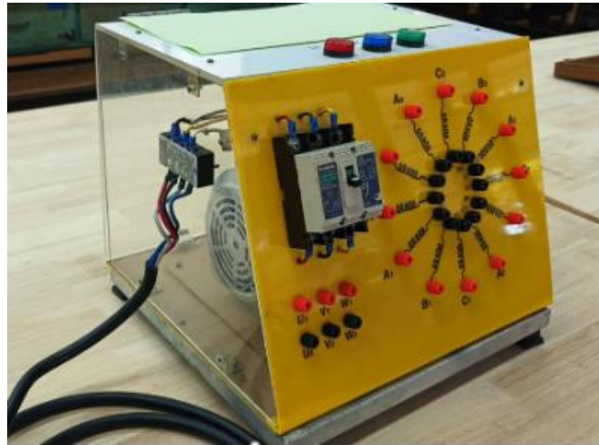
ภาพที่ 2 ชุดฝึกทักษะการต่อขดลวดสเตเตอร์ของมอเตอร์ไฟฟ้ากระแสสลับ 3 เฟส พันแบบ 2 ชั้น
