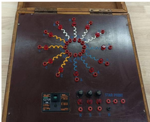
ภาพที่ 1 ชุดฝึกทักษะการต่อขดลวดสเตเตอร์ของมอเตอร์ไฟฟ้ากระแสสลับ 3 เฟส พันแบบ 2 ชั้น
