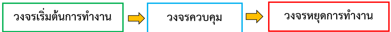
ภาพที่ 2 ลำดับขั้นตอนการแยกวงจรควบคุมเป็นชุด ๆ
