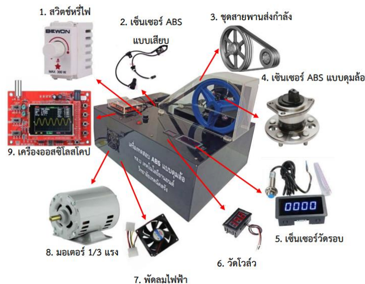
ภาพที่ 3 เครื่องทดสอบเซ็นเซอร์ ABS แบบคุมล้อ
