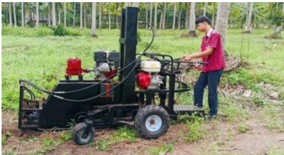
ภาพที่ 12 เครื่องขุดดินฝังท่อ
