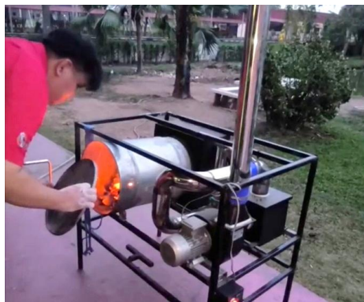
ภาพที่ 4 การทดลองเตาเผาขยะเพื่อลดมลพิษทางอากาศสำหรับชุมชน
