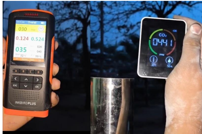
ภาพที่ 5 การใช้เครื่องมือวัดค่ามลพิษควันจากการเผาไหม้ของขยะ
